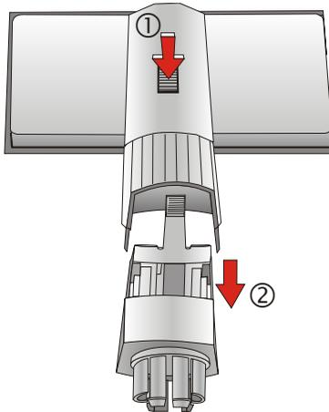
Drücken Sie den mit einem Pfeil gekennzeichneten Entriegelungsknopf (1) und ziehen Sie das Gelenk von der Kundenanzeige ab (2).
