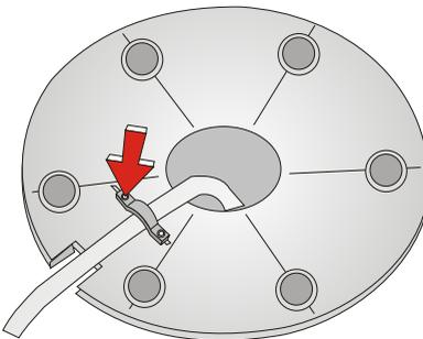
Auf der Unterseite des Standfußes befindet sich ein Metallbügel der Zugentlastung. Lösen Sie eine Schraube (s. Pfeil), schieben Sie den Bügel zur Seite und führen Sie das Anschlusskabel von innen unter den Metallbügel durch die Aussparung nach außen. Schrauben Sie den Bügel wieder fest.
