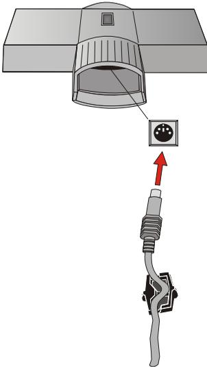
Stecken Sie den Kabelstecker in die Buchse in der Kundenanzeige und stecken Sie Adapter/Gelenk wieder auf die Kundenanzeige, bis es einrastet.
