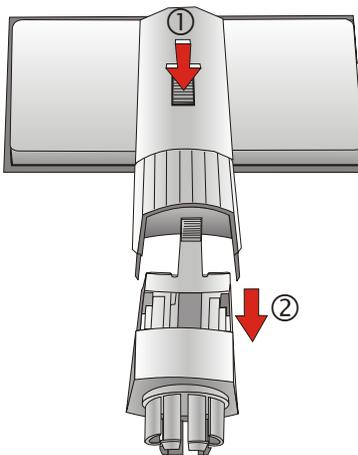
Drücken Sie den mit einem Pfeil gekennzeichneten Entriegelungsknopf (1) und ziehen Sie das Gelenk von der Kundenanzeige ab (2).
